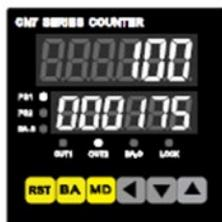
В режиме измерений нажмите клавишу «◀» для входа в режим изменения параметров, крайняя правая цифра начнет «мигать», нажмите клавишу «◀» еще 5 раз для перемещения позиции изменения параметра в крайнюю правую позицию.
